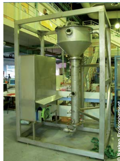
Pilote de cristallisation de struvite.
